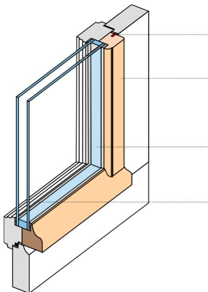
Grâce à l'étanchéité périphérique sur l'extérieur, la fenêtre est étanche au vent et aux intempéries.
